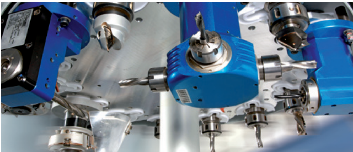
Magazynek talerzowy z 8 miejscami na narzędzia , przemieszczający się w osi X
