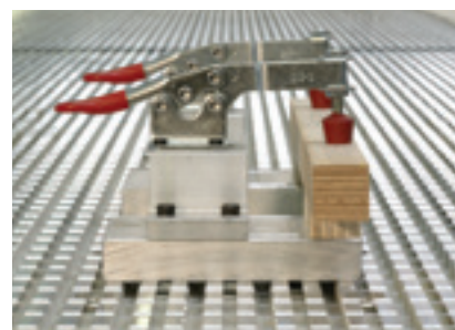
Mocowanie zacisków specjalnych Aluminiowy stół rastrowy z przewodnicami na jaskółczy ogon pozwala na precyzyjne zamocowanie zacisków gwarantujących zachowanie kształtu elementu obrabianego
