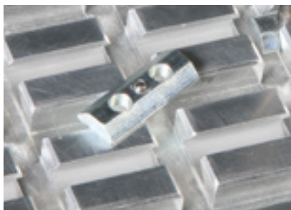
Kostka z gwintami do zamocowania w niej zacisków w prowadnicy na jaskółczy ogon
