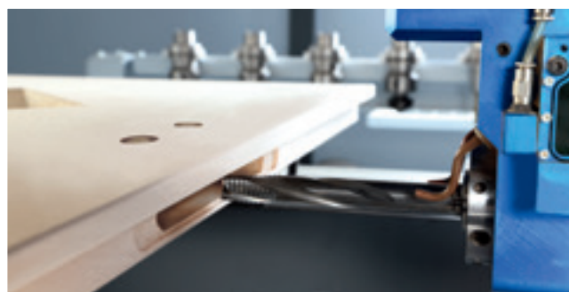
Frezowanie kieszeni pod zamki
