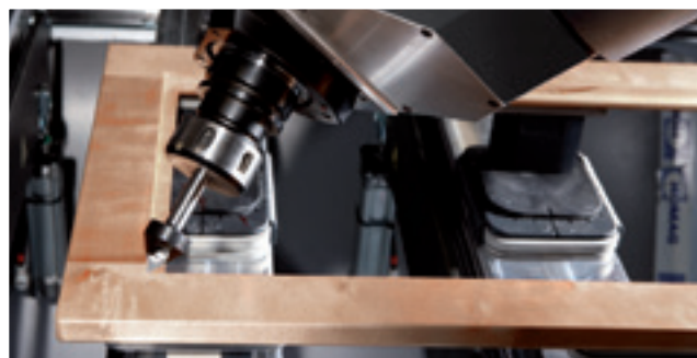
Frezowanie wpustów na szybę
