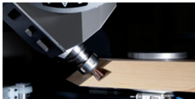
Frezowanie połączenia na jaskółczy ogon na belkach pionowych i konstrukcjach ramiakowych
